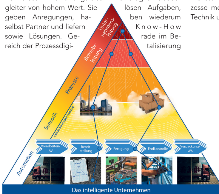
Automatisierungspyramide: Kommunikationsstruktur in der automatisierten Produktion
